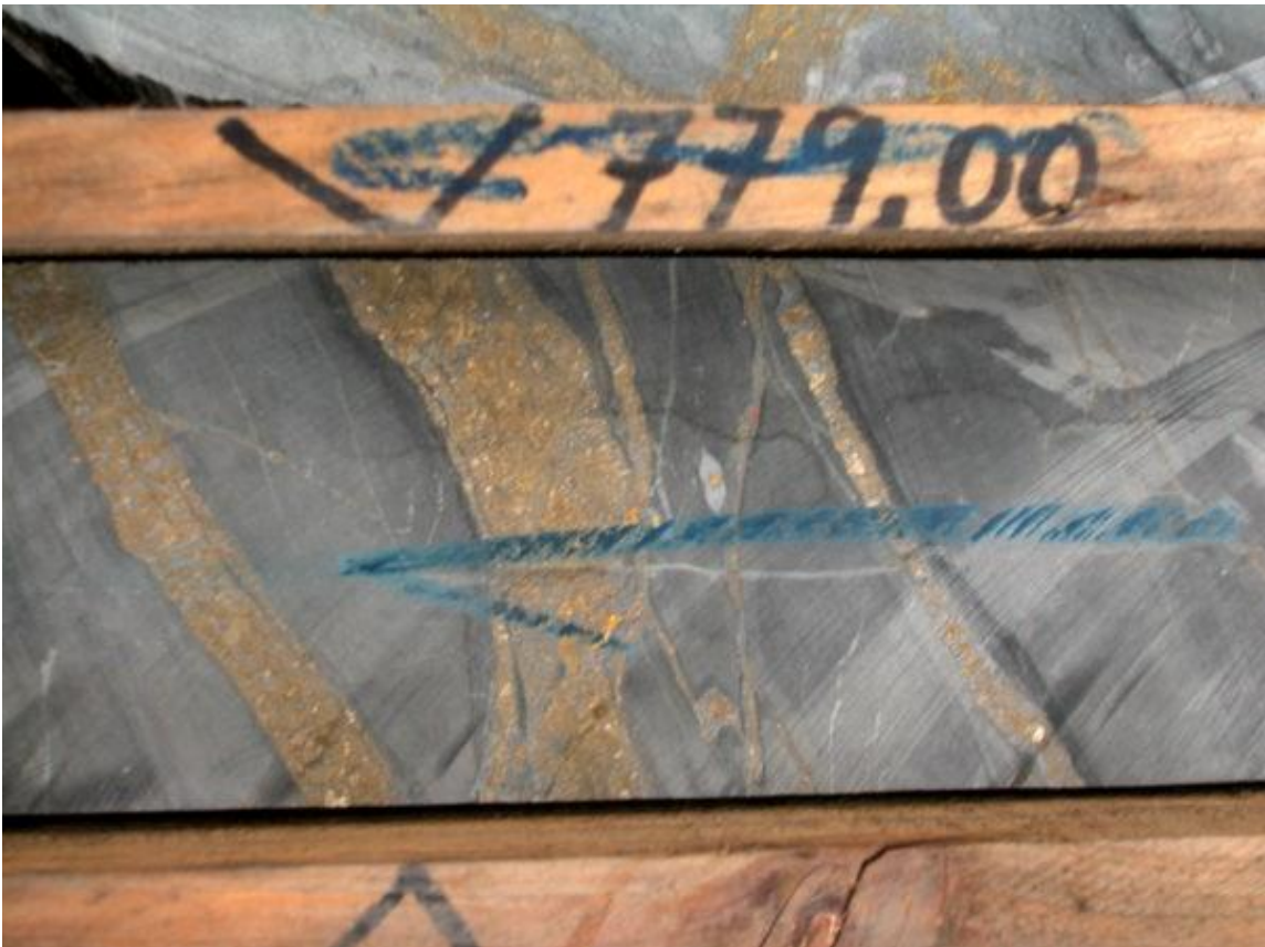
Testigo de sondeo que corta venas de calcopirita del stockwork. De aquí se recogieron los cristales de la foto anterior.
