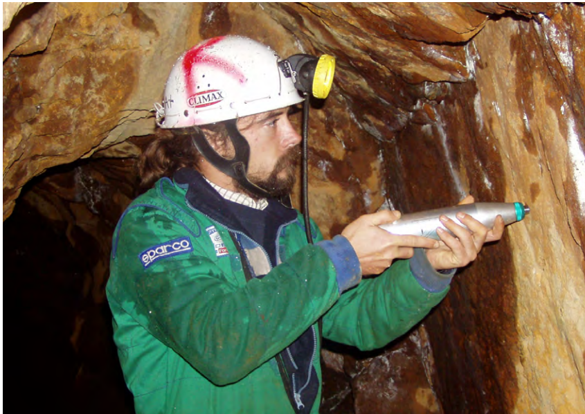
Figura 190: Medidas esclerométricas en el interior de la mina de Bustarviejo.
