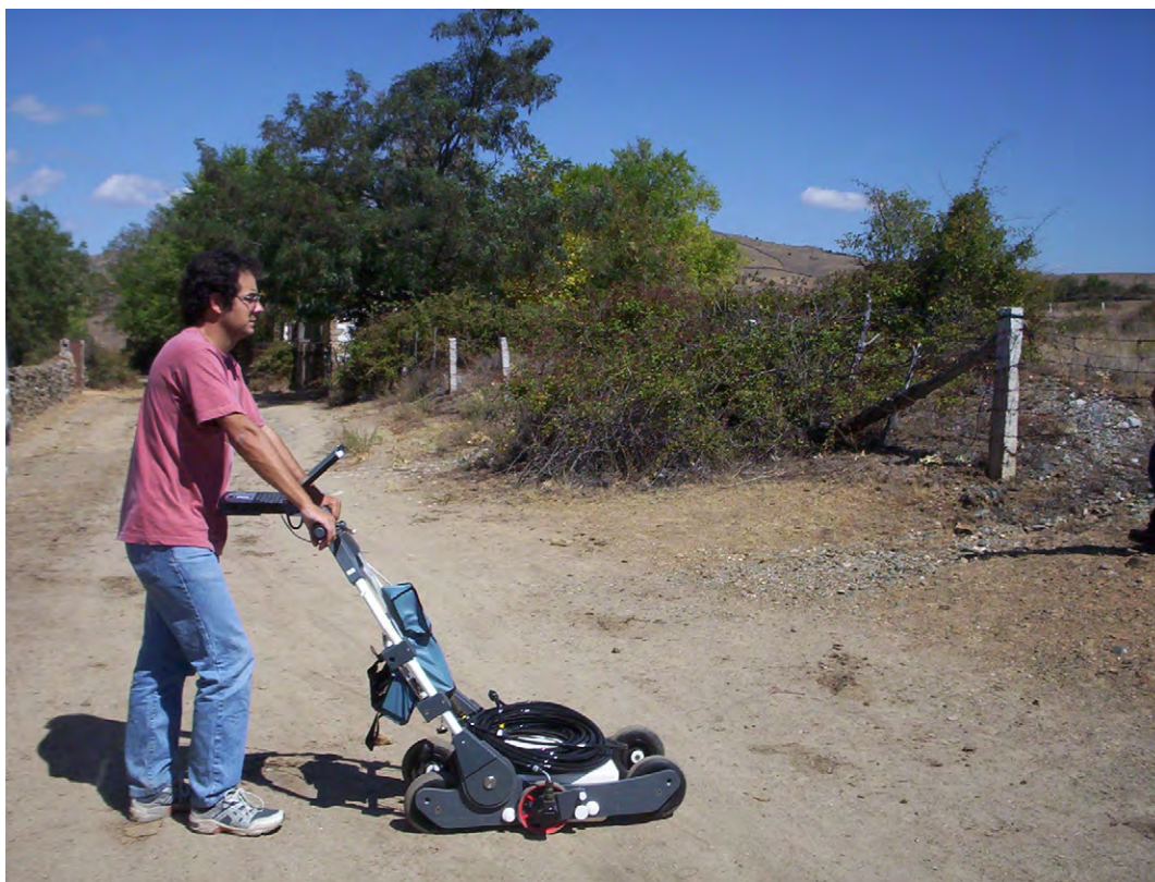
Figura 123: Equipo de georadar trabajando en mina Fernandito, al aplomo de la galería que pasa bajo el camino (2005).
