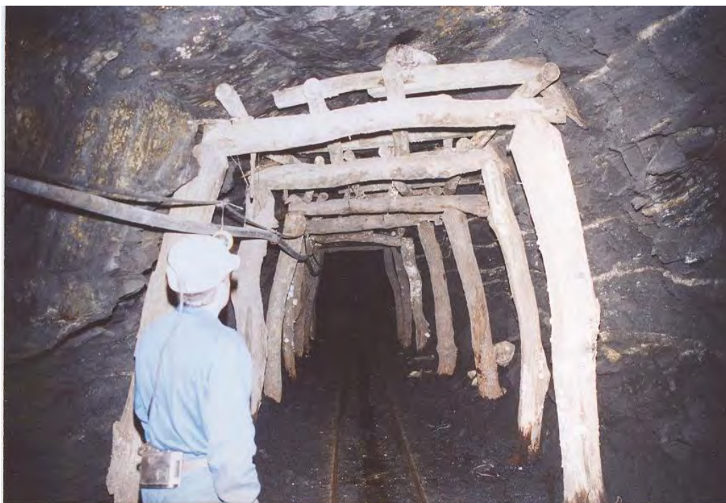
Figura 52: Fila de cuadros en la galería principal de la mina Solita de Bembibre.
