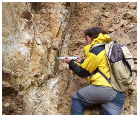
Figura 27: Medidas esclerométricas sobre juntas en el emboquille de una mina. Figura 28: Detalle del esclerómetro o martillo Schmidt.
