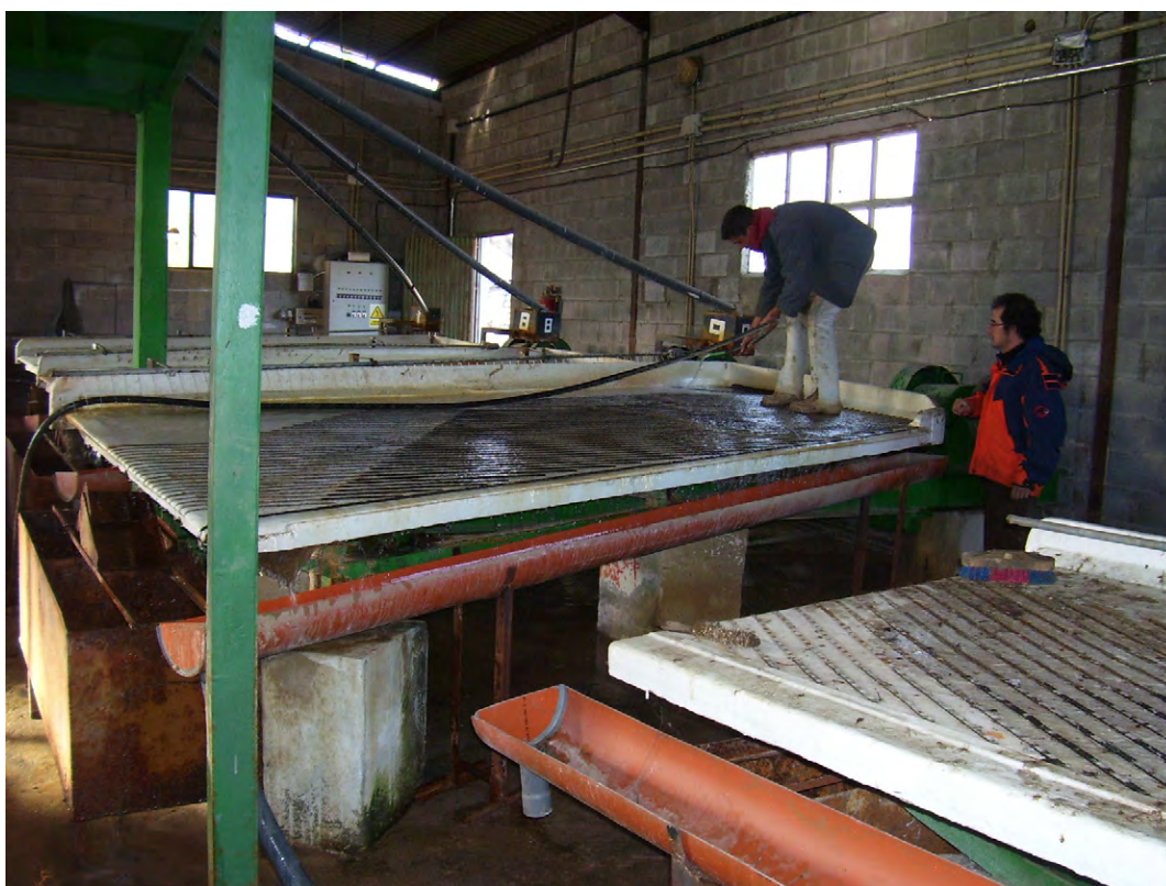
Figura 143: Trabajos de mantenimiento de las mesas de sacudidas de la mina Maribel, en Galapagar (2006).
