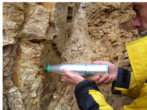
Figura 27: Medidas esclerométricas sobre juntas en el emboquille de una mina. Figura 28: Detalle del esclerómetro o martillo Schmidt.
