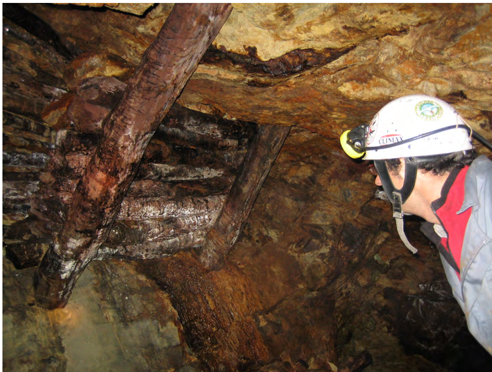
Figura 132: Detalle de una llave de madera en la mina de plata d Bustarviejo. Probablemente anterior al siglo XIX. Fotografía tomada en 2007.
