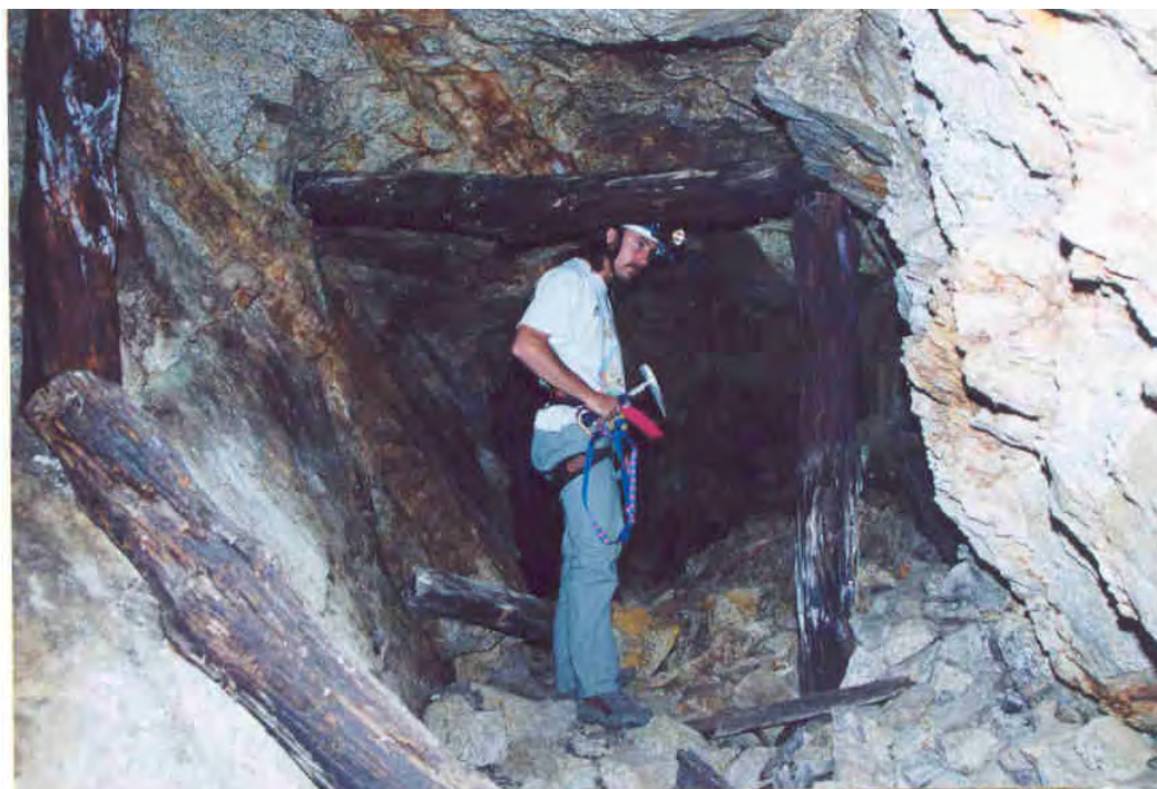
Figura 111: Galería de la mina de Nuestro Padre Jesús (2002). Nótese a la izquierda dos filones mineralizados.
