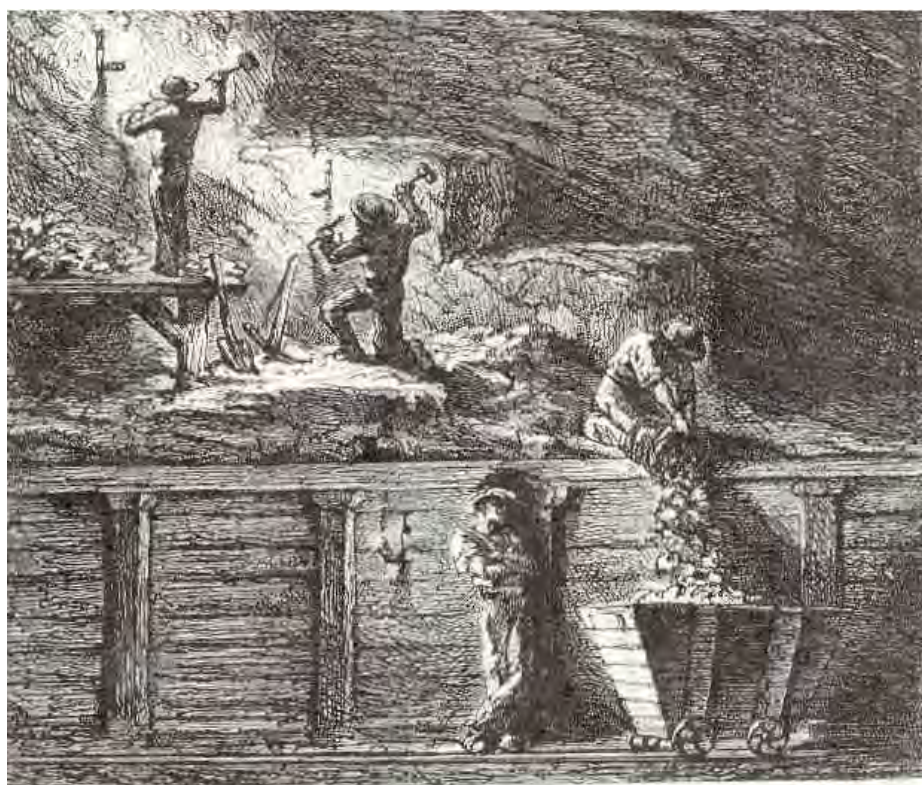
Figura 120: Explotación por realces y coladeros. Tomado de “La vie souterraine”, Simonin (1867). El minero de la izquierda esta picando sobre una “camada de estemples”.
