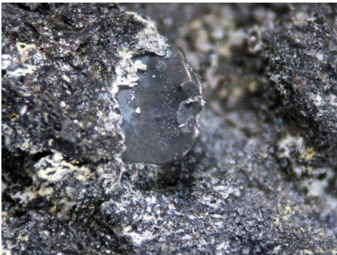
Plomo metálico en la matriz. El material blanco es hidrocerusita
